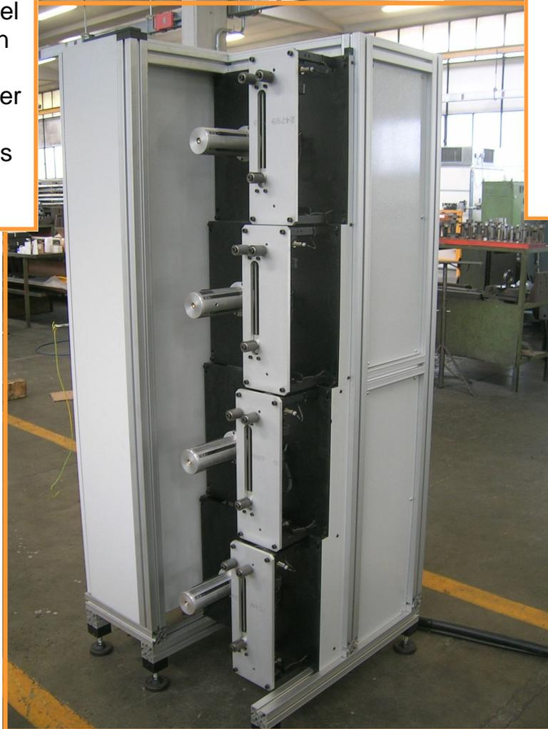
Der selbsttraversierende Aufwickler fuer Baender AV 4x220 CA 60 ist ein mehrfacher Aufwickler mit unabhangigen Aufnahmespulen. Er ist mit einer SPS ausgestattet welche ermoglicht die Verlegesteigung der Baender mit kontrollierter Zugspannung zu programmieren. Die moeglichen Einstellungen sind: kontinuierliche Spirale, Windung an Windung, feste Steigung mit regelmaessigen oder bikonischen Flanschen.
